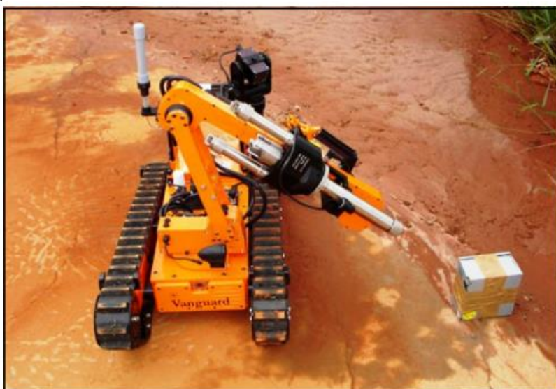
Figura 5 – Robô antibombas dotado de canhão disruptor, treinamento realizado em Brasília (2009).
