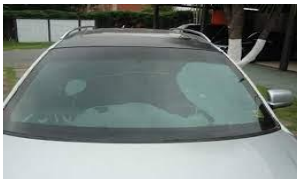
Imagem 6 – Delaminação do vidro blindado
